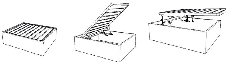
1) Rete perforata come da disegno di dimensioni 1600x1900mm in tubolare 50x25 per cassone di dimensioni interne 1630x1930mm completa di barra di trasmissione.
